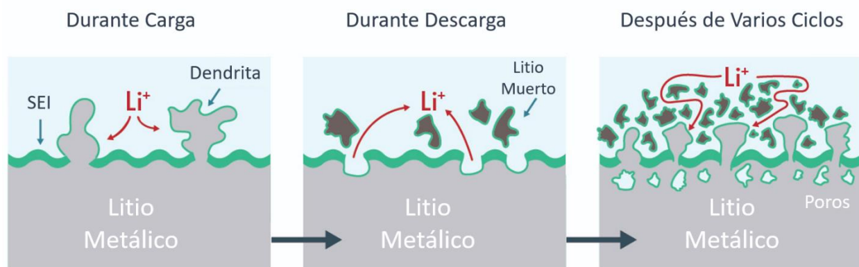
Figura 1.4: Esquema de la formación de Litio muerto y la degradación del ánodo de litio durante su funcionamiento[31]
