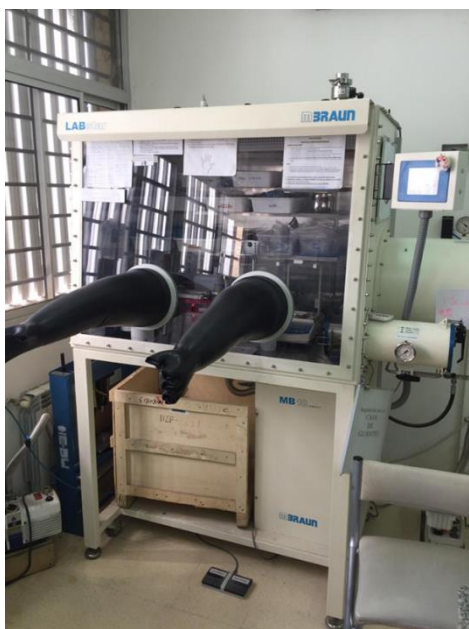
Figura 2.2: (Izquierda) Fotografía de la caja de guantes M-Braun MB10 compact del Laboratorio de Energías Sustentables utilizado para la fabricación de las celdas electroquímicas. (Derecha) Esquema del ensamblado de una celda electroquímica del tipo moneda ( coin cell ) 2032
